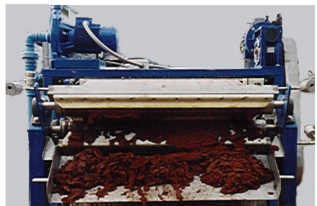
FILTRO BANDA AKFB 1000 LODO FISICOQUIMICO
